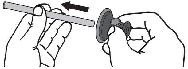
6. Insérer la nouvelle tige à roulette micrométrique dans le trusquin, comme l'illustre la figure ci-dessous.
