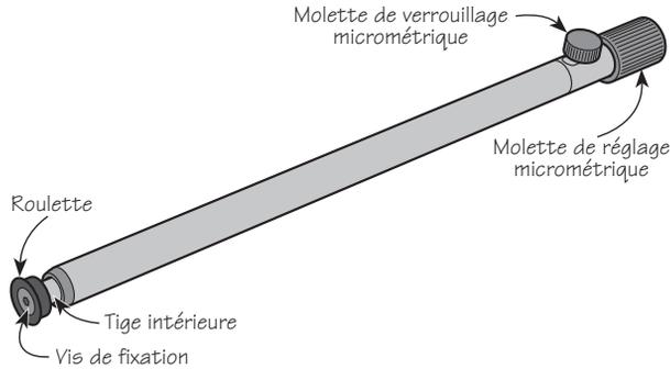
Pour remplacer la tige de n'importe quel trusquin doté d'une tige de 5/16 po de diamètre :
