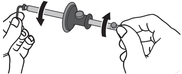
9. Tourner la molette de réglage micrométrique en sens antihoraire afin de relâcher le coincement du filetage causé par le serrage de la vis de fixation de la roulette.
