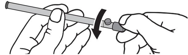
3. Retirer la vis de fixation de la roulette et la roulette.
